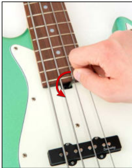
Straffer Halsstab mit Halskrümmung nach hinten (konvex), tiefe Saitenlage.
