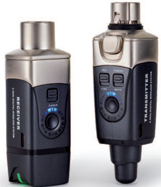
Das XVive U3 Microphone Wireless System schwimmt auf der Welle, die Zeck Mitte der 1990er Jahre mit dem Daisy System prägte: Ein XLR-Dongle enthält jeweils einen Sender und Empfänger und kann somit direkt auf das Mikrofon beziehungsweise in den Kanal am Mischpult eingesteckt werden
